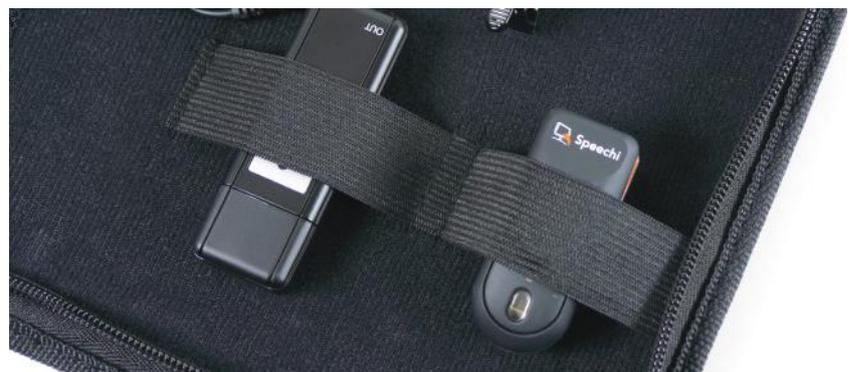
**L'émetteur** cravate pèse 15 grammes et contient une batterie rechargeable sur prise USB (2h de charge pour 6 à 8 h d'usage continu). L'émetteur vous permet aussi de régler le volume du micro et dispose d'un mode « muet ».
